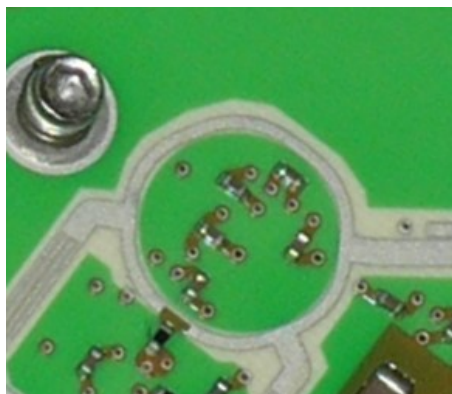
Abbildung 3.3.3: Beispiel eines Rat-Race Kopplers
