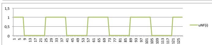
Frage 2.3.1: Erstellen Sie mit Hilfe Ihrer Tabellenkalkulation ein FSK-Signal. Zu den Zuständen  $u_{NF}(m) = 0$  oder  $u_{NF}(m) = 1$  soll hierbei zwischen den Frequenzen  $f_{T1}$  und  $f_{T2}$  umgeschaltet werden. Eine Möglichkeit hierbei besteht in der Wahl  $f_{T1} = 2 f_{T2}$ .
