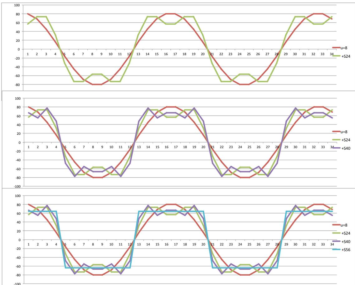
*Approximation des Rechtecksignals durch Überlagerung der spektralen Komponenten*
