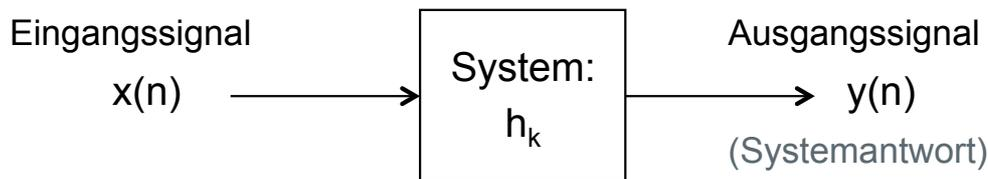
Rechnerisch ermittelt man die Antwort des Systems  $y(n)$  auf ein Eingangssignal  $x(n)$  nach der Vorschrift gemäß Gleichung (3.1). Liegt die Systembeschreibung  $h_k$  beispielsweise mit insgesamt 5 Stützstellen vor, so ergibt sich aus Gleichung (3.1):
