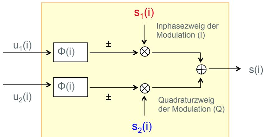
Als Eingangssignale werden willkürliche Bitfolgen  $u_1(m)$  und  $u_2(m)$  angenommen. Hierbei ist jeder Wert  $u_1(m)$  und  $u_2(m)$  auf eine Periodenlänge von jeweils 4 Stützstellen zu erweitern, so dass eine Verarbeitung mit den Trägern  $s_1(i)$  und  $s_2(i)$  möglich ist.
