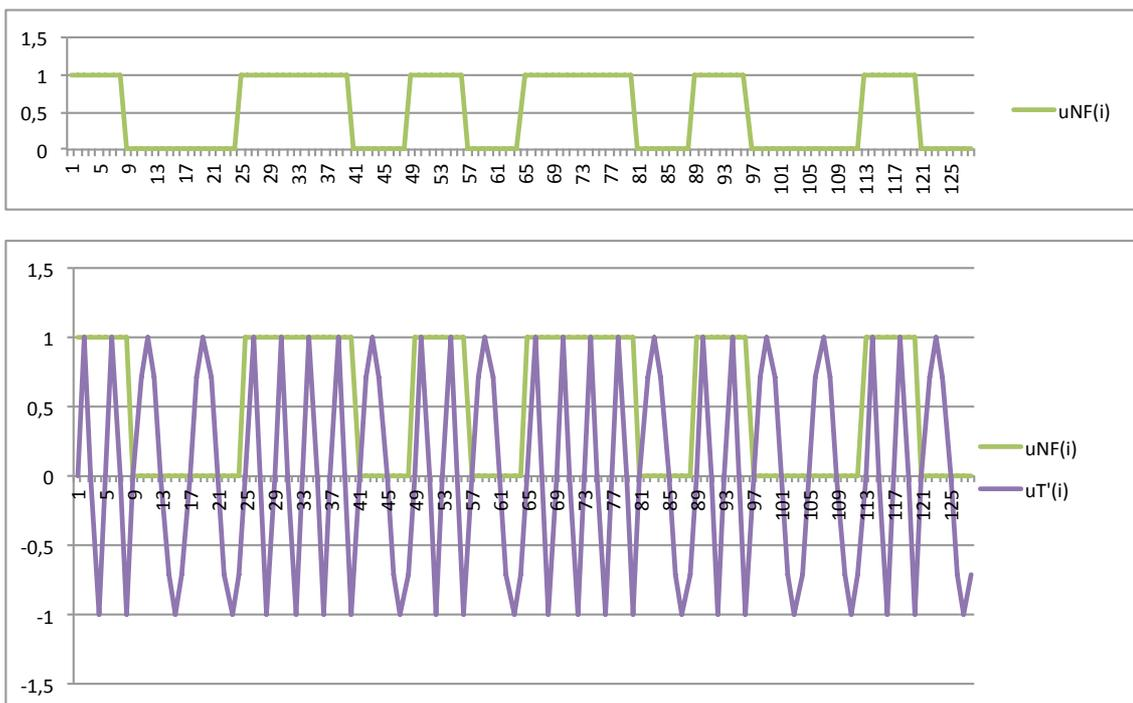
Die Umschaltungen finden hier jeweils in den Nulldurchgängen der Träger statt. Beide Träger sind synchron (was sich in diesem Fall z.B. durch einen Teiler leicht bewerkstelligen lässt). Ein anderes Schema zur Kodierung verwendet insgesamt 4 Zustände der Trägersignale an den Übergabestellen:  $+f_{T1}, -f_{T1}, +f_{T2}, -f_{T2}$ .
