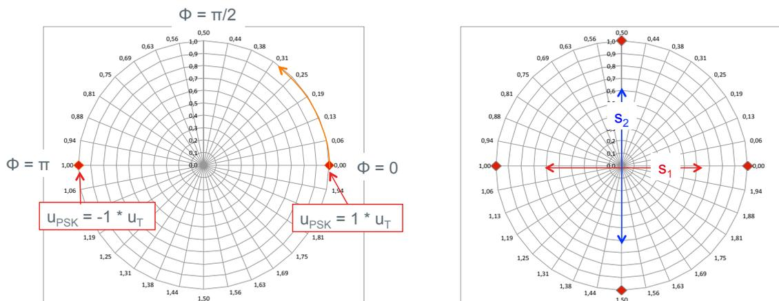
Bei der PSK-Modulation sind die diskreten Phasen des Trägers  $\phi_0=0$  und  $\phi_1=\pi$ . Das Vorzeichen des Trägers wird also im Falle  $\phi_2=\pi$  invertiert. Der Träger schwankt zwischen den Werten  $u_T = 1$  und  $u_T = -1$ . Betrachtet man die x-Achse des Diagramms als reelle Achse, so schwingt das Signal  $s_1$  also in dieser Richtung, wobei die Phase zwischen 0 und  $\pi$  getaktet wird. Dieser Zusammenhang ist auf der linken Seite der Abbildung dargestellt.
