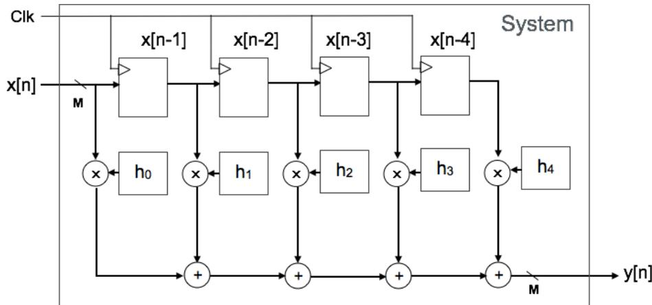
Man erkennt links das Eingangssignal  $x(n)$ , rechts das Ausgangssignal  $y(n)$ , sowie die Systemkoeffizienten  $h_0$  bis  $h_4$ , die in Registern für die Multiplikation vorgehalten werden. Die Schaltung ist getaktet (siehe Signal Clk oben). Die Register oben funktionieren als Schieberegister und dienen zur Speicherung der vergangenen Werte  $x(n-i)$ , die für die Berechnung benötigt werden.
