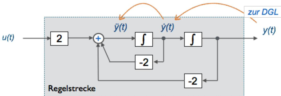
Die Rückkopplungen sind für das Einschwingverhalten verantwortlich. Setzt man beide Koeffizienten in den Rückkopplungszweigen gleich Null, so verbleibt nur  $\dot{y}(t) = 2 u(t)$ .
