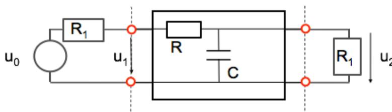
Frage 3.3.1: Ergänzen Sie die Ströme im Schaltbild. Erstellen Sie die Differenzialgleichung für  $u_2(t)$  in Abhängigkeit von  $u_1(t)$ . Wie lautet die Differenzialgleichung für den Fall, dass  $R_1 \gg R$  ist (d.h.  $i_{R_1}(t)$  vernachlässigt werden kann)?
