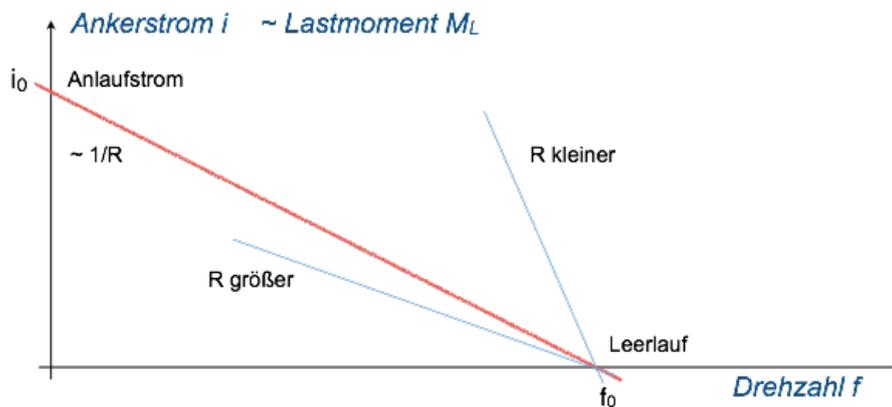
Bild 1.3 Drehmoment-Drehzahl Kennlinie
