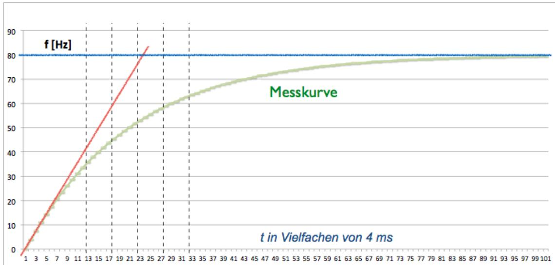
Lösung: (1) Die Zeitkonstante liest man ab zu  $\tau = 25 * 4 \text{ ms} = 100 \text{ ms} = 0,1 \text{ s}$ . (2) Der Faktor  $b$  in der Übertragungsfunktion ergibt sich aus dem Grenzwert der Sprungantwort im eingeschwungenen Zustand:  $h(t \rightarrow \infty) = G(s \rightarrow 0) = b = 80 \text{ Hz} / 24\text{V} = 3,33 \text{ Hz/V}$ . Die Skalierung auf die Höhe der Sprungfunktion von 24V ist erforderlich, da für den Grenzwertsatz ein Einheits-sprung verwendet wurde.
