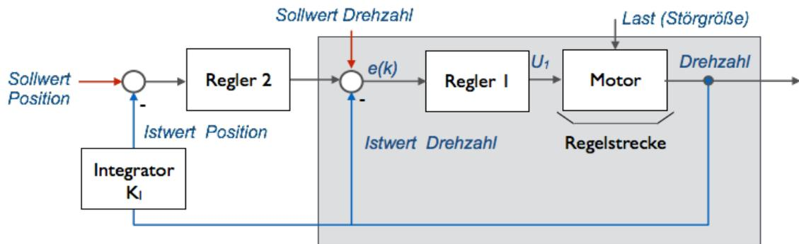
Aus der Drehzahl wird durch Integration über der Zeit und Multiplikation mit dem Faktor  $K_i$  die Position abgeleitet ( $s = K_i \int f(\tau) d\tau$ ). Die Abweichung der Position vom Sollwert dient als Eingang für den überlagerten Regler 2, der als Proportionalregler (P-Regler) ausgeführt wird.
