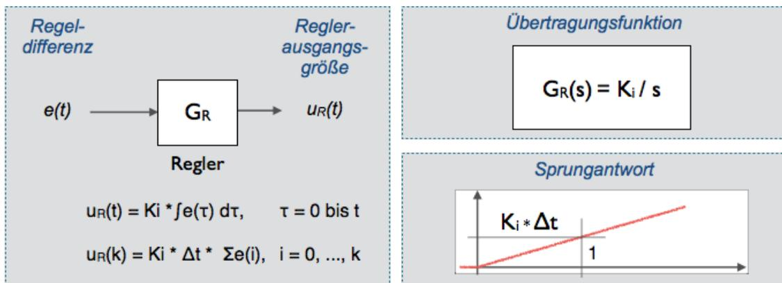
Bild 1.10 I-Regler als System mit Sprungantwort und Übertragungsfunktion
