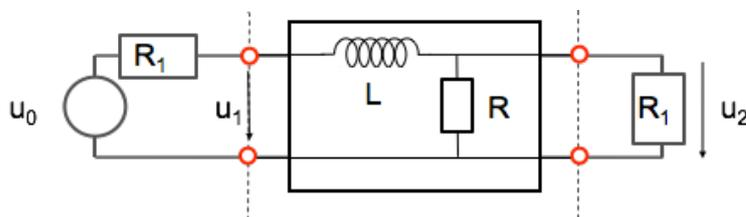
Frage 3.6.1: Ergänzen Sie die Ströme im Schaltbild. Erstellen Sie die Differentialgleichung für  $u_2(t)$  in Abhängigkeit von  $u_1(t)$ . Wie lautet die Differentialgleichung für den Fall, dass  $R_1 \gg R$  ist (d.h.  $i_{R_1}(t)$  vernachlässigt werden kann)?
