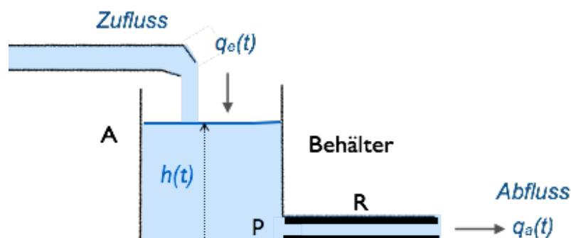
Hierbei bedeuten A (in m<sup>2</sup>) die Fläche des Behälters und ρ die Dichte der Flüssigkeit (in kg/m<sup>3</sup>). Am Boden des Behälters beträgt der Druck p der Flüssigkeit  $p = \rho g h$ , wobei h die Füllhöhe bezeichnet. Dieser Druck p treibt die Flüssigkeit aus dem Behälter. Die ausströmende Menge  $q_a$  beträgt  $q_a = p/R$ , wobei R den hydraulischen Widerstand bezeichnet.
