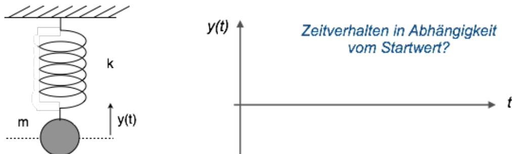
Frage 3.1.1: Beschreiben Sie das zeitliche Verhalten des Systems durch eine Gleichung. Hinweis: Gehen Sie davon aus, dass (1) die Kraft  $F$  die Masse  $m$  beschleunigt ( $F = m a$ ), (2) dass diese Kraft um die Federkonstante  $k$  proportional zur Auslenkung  $y$  der Masse ist ( $F = k y$ ).
