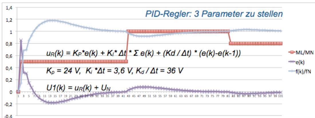
Bild 1.13 Drehzahlregelung mit PID-Regler
