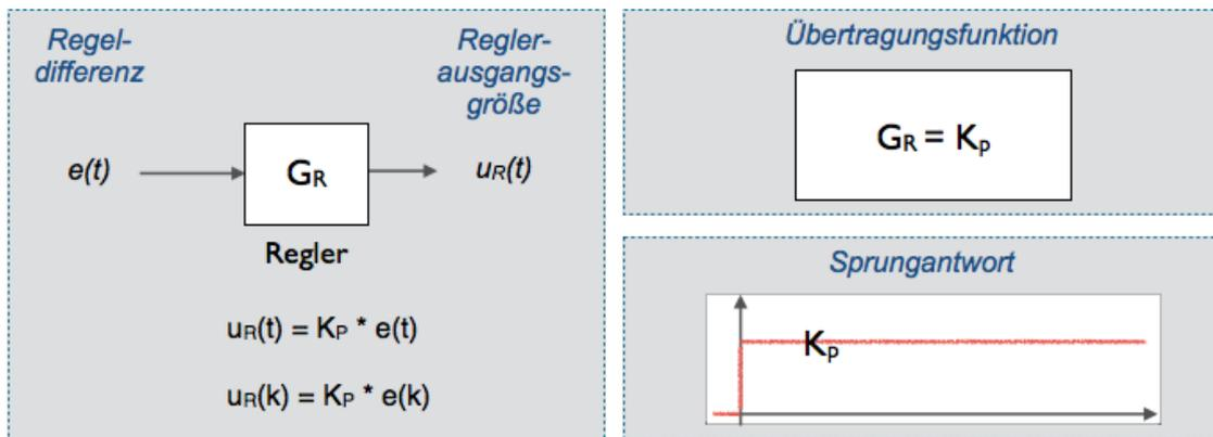
Bild 1.8 P-Regler als System mit Sprungantwort und Übertragungsfunktion
