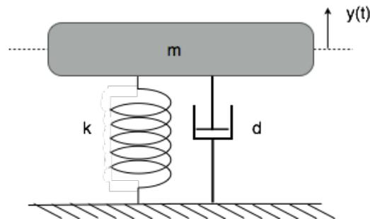
Frage 3.20.1: Erstellen Sie die Differenzialgleichung. Hinweis: Die Dämpfung ist proportional zur Geschwindigkeit, d.h.  $F_d = d \dot{y}(t)$ .
