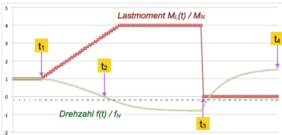
Das Diagramm zeigt eine normierte Darstellung des Verlaufs der Störgröße (Lastmoment) und der Ausgangsgröße (Drehzahl). Aus welchem Zustand startet das System? Erläutern Sie das Verhalten des Systems zu den in der Abbildung gezeigten Zeitpunkten und zwischen diesen Zeitpunkten.
