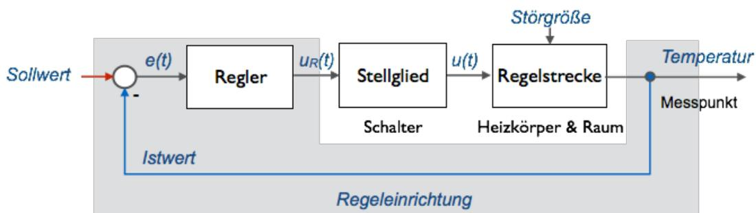
Dem Regler stehen als Eingangssignale zur Verfügung: (1) ein per Drehknopf einstellbarer Wert für die gewünschte Raumtemperatur, (2) ein Messwert der aktuellen Raumtemperatur. In der Praxis ist eine solche Regelung direkt am elektrischen Heizkörper angebracht.
