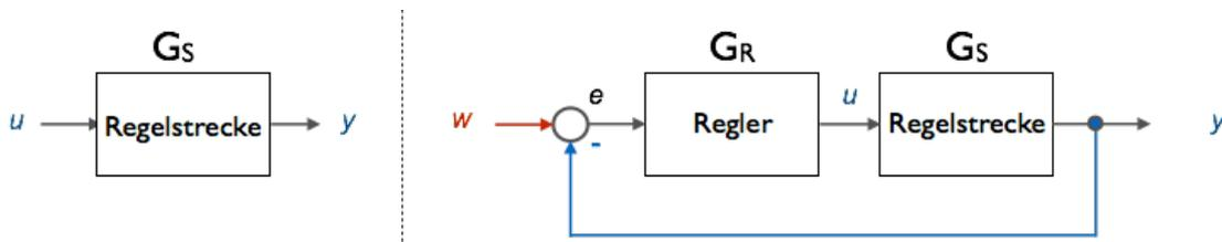
Bild 1.14 Vergleich der unregelten mit der geregelten Strecke
