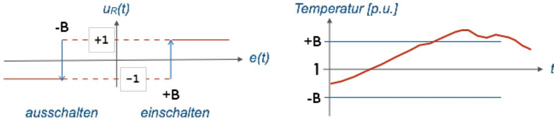
Der Regler soll so arbeiten, dass er bei Überschreiten der mit dem Drehknopf eingestellten Temperatur um die Bandbreite B das Heizelement abschaltet ( $u_R(t) = -1$ ), bei Unterschreiten der eingestellten Temperatur um die Bandbreite B das Heizelement einschaltet ( $u_R(t) = +1$ ). In der Abbildung oben ist die relative Temperatur  $T/T_{\text{Soll}}$  dargestellt (normiert auf den Nennwert im sogenannten per unit System, p.u.).
