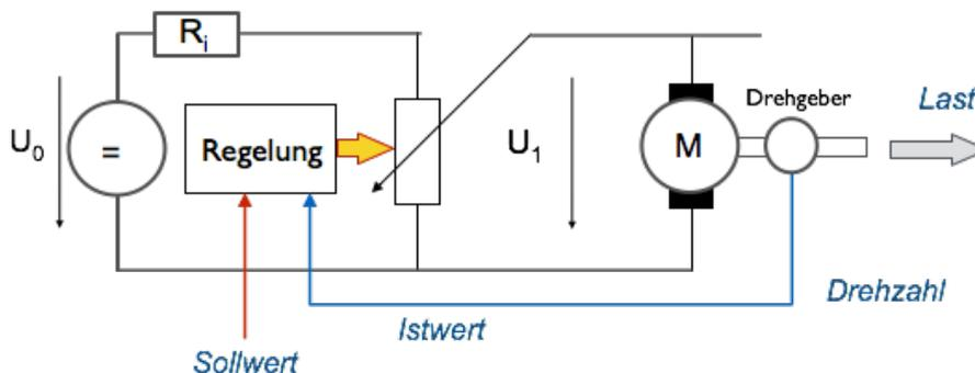
Bild 1.5 Erweiterung der Steuerung zu einer Regelung
