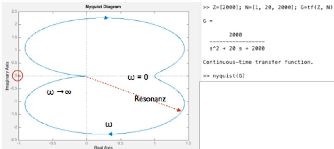
Frage 3.28.5: Amplitudenreserve und Phasenreserve. In die Ortskurve in Frage 3.28.5 darf der Punkt  $(-1, 0)$  in der komplexen Ebene auf keinen Fall eingeschlossen werden. Die Ortskurve sollte ihn links liegen lassen. Übersetzt man diese Eigenschaft in den Amplitudengang und Phasengang, so liegt der kritische Punkt  $(-1, 0)$  bei der Phase 180 Grad.
