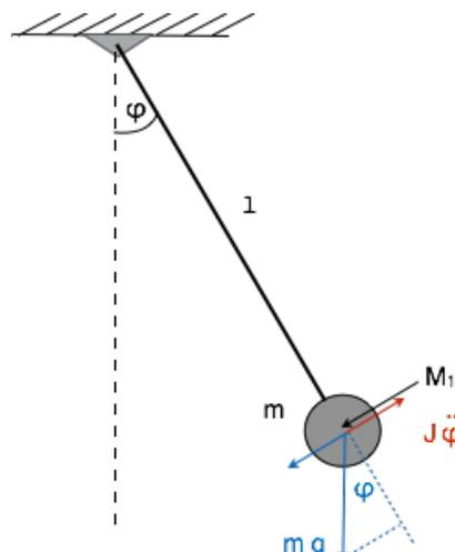
Frage 3.21.1: Erstellen Sie die Differenzialgleichung. Hinweis: Das Massenträgheitsmoment der Masse  $m$  am Seil der Länge  $l$  berechnet sich zu  $J = m l^2$ . Als äußere Anregung wirkt das Moment  $M_1$  ein. Es soll nur um kleine Winkel  $\phi$  ausgelenkt werden.
