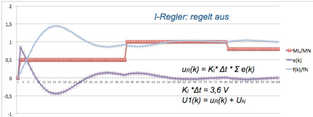
Bild 1.9 Drehzahlregelung mit I-Regler
