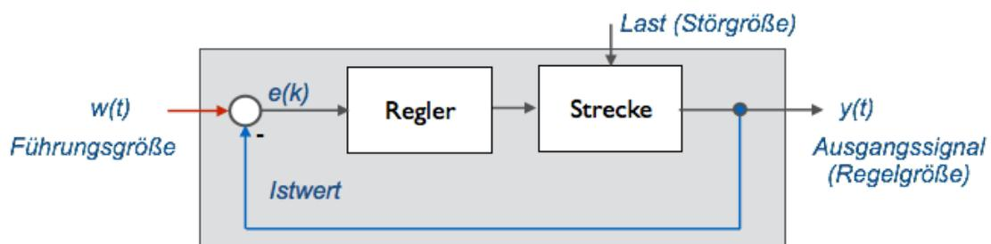
Bei dem in der Abbildung gezeigten Regelkreis sei die Regelstrecke ein System erster Ordnung mit der Übertragungsfunktion  $G_S(s) = b / (s + a)$ . Für den Regler wird ein I-Regler mit der Übertragungsfunktion  $G_R(s) = K/s$  verwendet.
