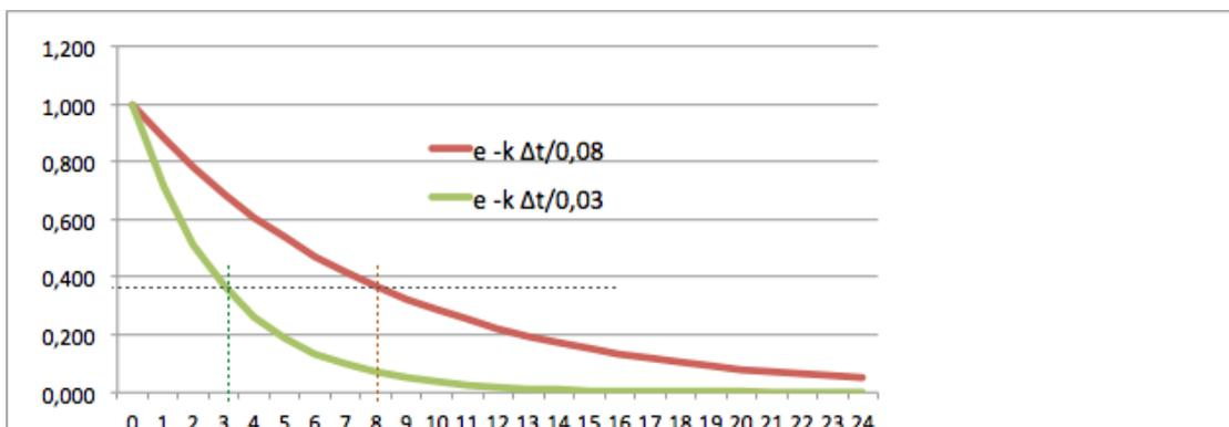
Bild 1.15 Einfluss des Reglers auf das Einschwingverhalten
