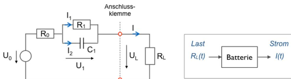
Bild 3.1.1 Elektrische Ersatzschaltung des Batteriemodells
