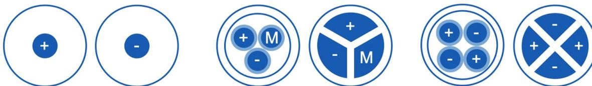
Bild 2.1.3 Leiter in Niederspannungskabeln
